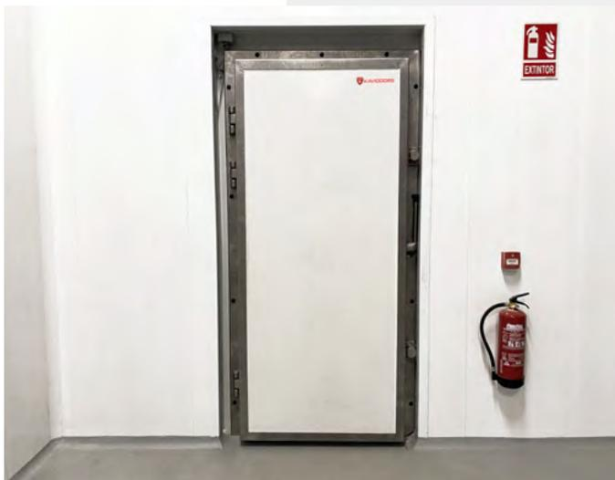
Les **portes pivotantes frigorifiques coupe-feu Kavidoors** modèle Ei2-60, ont été fabriquées avec acier inox. Les éléments d'structure du vantail, cadre et ferrures, en réussissant ainsi supporter les essais auxquels elle a été soumise pour sa certification. Cette porte a été pensée pour être installées dans des chambres froides avec des températures oscillant entre +0 °C et -20°C / -40°C .
